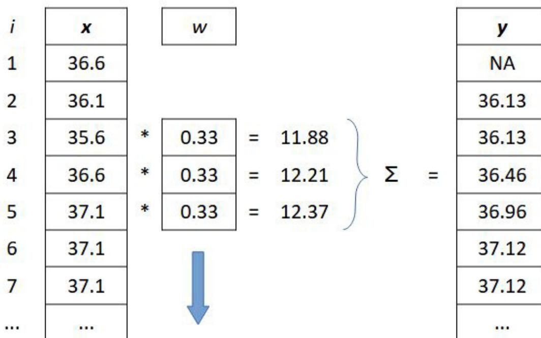
Рис. 5. Скользящая средняя: процесс расчета четвертого ( $i = 4$ ) значения ряда  $y$  с использованием трех значений ряда  $x$  и трех значений фильтра  $w$  ( $h = 3$ )
