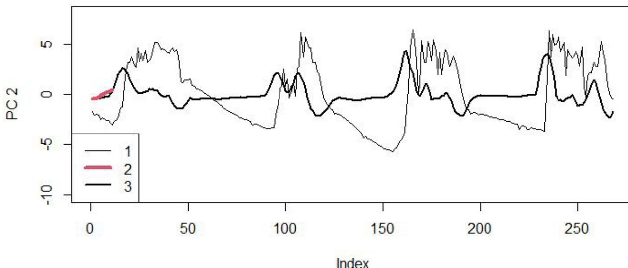
Рис. 21. Сглаживание с помощью второй главной компоненты (окно  $h = 11$ ); 1 – исходные шкалированные данные ( $st[,7]*3.2$ ), 2 – форма фильтра PC2 (график факторных нагрузок второй компоненты,  $m.e\$values[,2]$ ), 3 – значения второй главной компоненты
