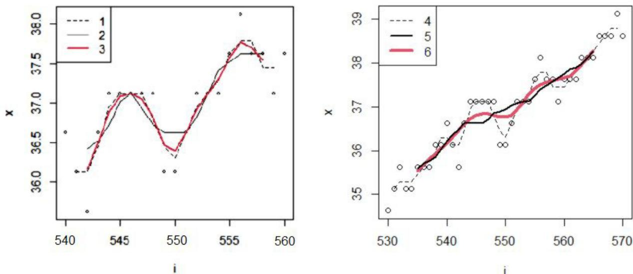
Рис. 7. Ряды значений температуры, сглаженные разными фильтрами: 1 – плоский ( $h = 3$ ), 2 – плоский ( $h = 5$ ), 3 – треугольный ( $h = 5$ ), 4 – плоский ( $h = 3$ ), 5 – плоский ( $h = 11$ ), 6 – параболический (Ланцоша) ( $h = 11$ )
