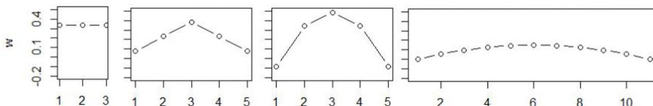
Рис. 6. Формы окон фильтров: прямоугольное, треугольное, Шеппарда, Ланцоша
