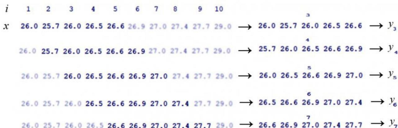
Рис. 1. Схема работы скользящего окна ( $h = 5$ ): из ряда динамики температуры тела ( $x$ ) последовательно отбираются по 5 соседних значений, из которых формируется таблица для расчета сглаженных значений температуры тела ( $y$ )
