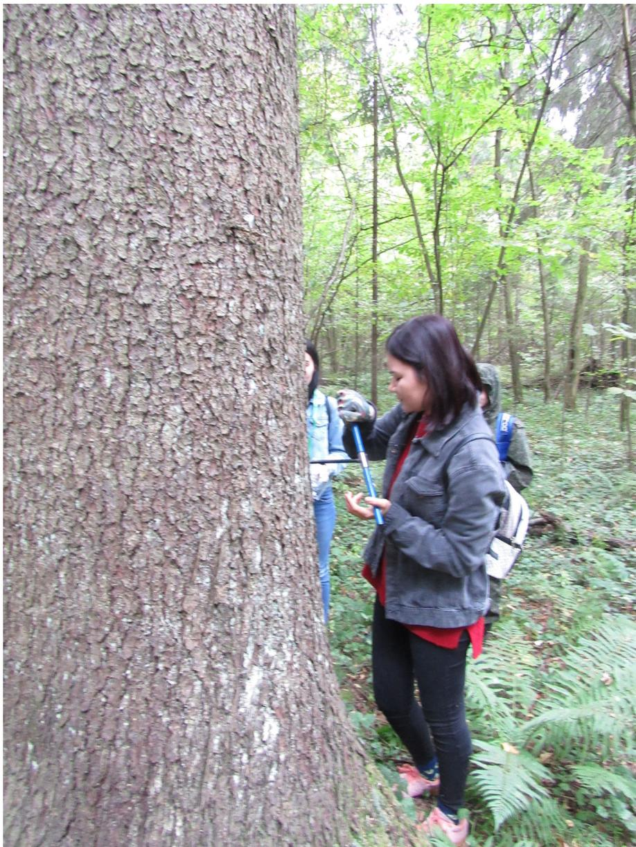
Рис. 3. Отбор керна древесины для диагностики гнили в стволе дерева
