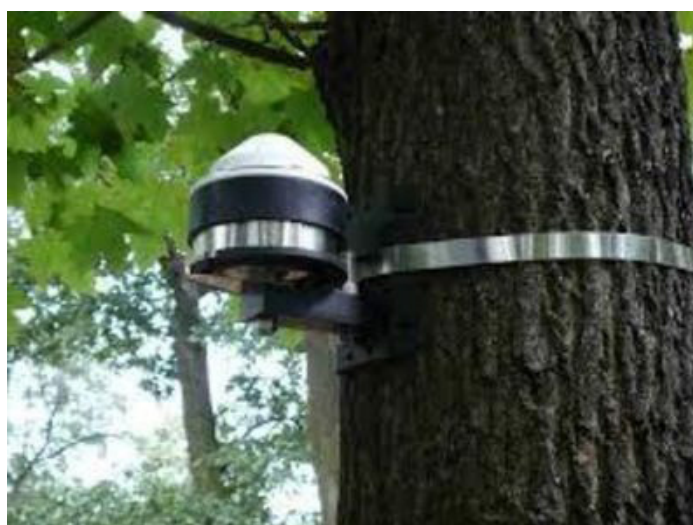
Рис. 2. Дендрометр DRL26C в рабочем положении Fig. 2/ Dendrometer DRL26C in working position
