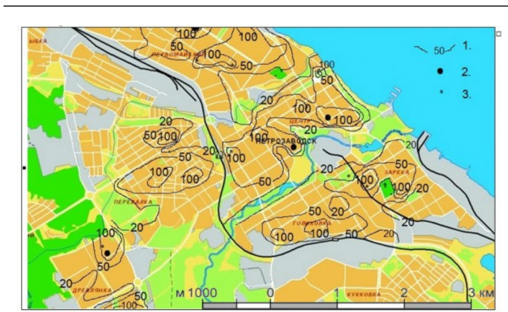
Рис. 2. Схематическая карта значений магнитной индукции в пределах территории г. Петрозаводска. Условные обозначения: 1. Изолинии и их оцифровка, нТл. 2. Аномалии по 3б пределу. 3. Аномалии по 2б пределу
